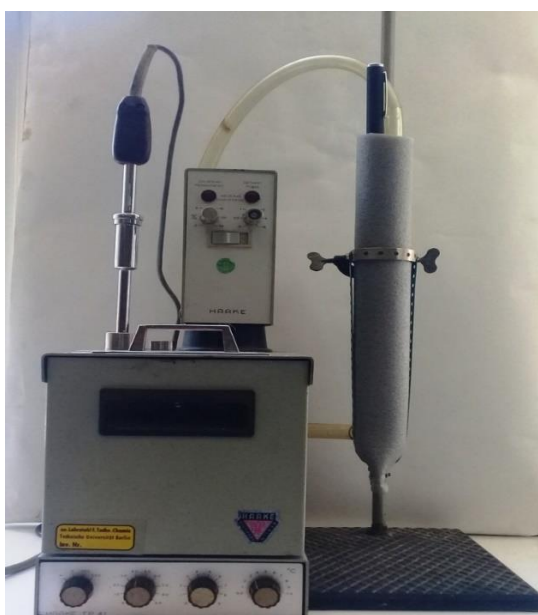
Fig. 3.1. Imagenă a instalației pentru tratarea semințelor cu laser.
