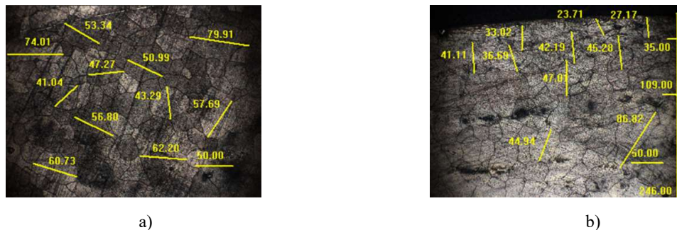
FIGURA 54 Microstructura aliajului de magneziu AZ31B-F neprelucrat (a) și prelucrat prin frezare (b) ( V_c=350 [m/min], f_z=0.08 [mm/dinte], a_p=0.6 [mm])
