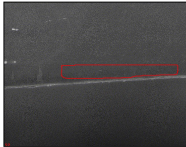
FIGURA 64 Analiza compoziției chimice (EDX) a straturilor adânci a aliajului de magneziu AZ31B-F prelucrat prin deformașchiere simultană ( P=60 [bar], a_{pt}=0.75 [mm], V_c=350 [m/min], f_z=0.08 [mm/dinte], a_p=0.6 [mm], deplasare în sensul avans )
