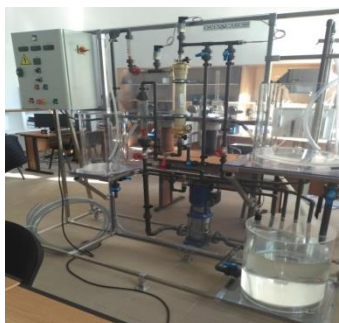
Fig. 1. Instalația pilot de ultrafiltrare MP 90 [1].
