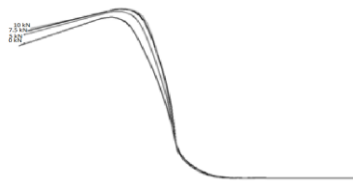
Fig. 5.30 Influența forței de reținere asupra revenirii elastice
