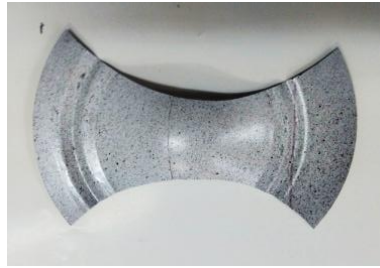
Fig. 3.31.c Deformările maxime ale epruvetelor
