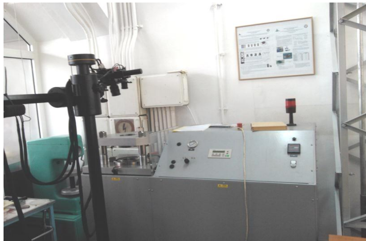
Fig. 3.21 Masina de incercare pentru testul Nakazima
