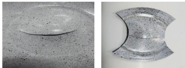
Fig. 3.31.b Deformările maxime ale epruvetelor
