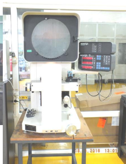
c. Instalația de măsurat în coordonate
