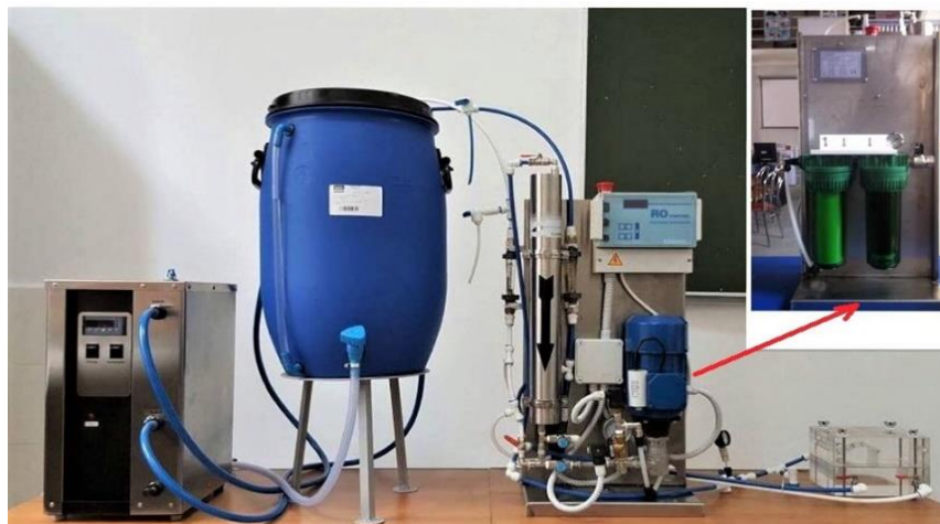
Fig. 4.11. Imagine cu instalația echipată cu membrană polimerică de OI și celula de flux, de la Universitatea „Vasile Alecsandri” din Bacău, România:
