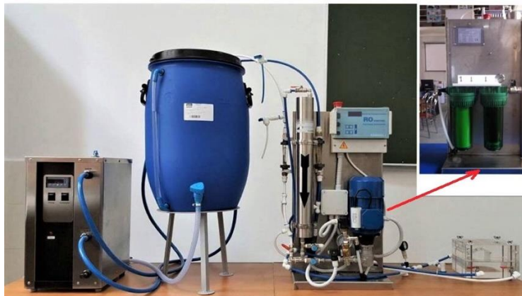
Fig. 4.11. Imagen de la planta equipada con membrana polimérica de OI y célula de flujo de la Universidad "Vasile Alecsandri" de Bacau, Rumanía:
